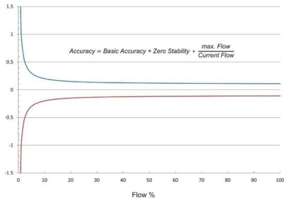
\*\*\*El cálculo de error se basa en los datos de especificación de la Información Técnica (TI) del caudalímetro seleccionado.
